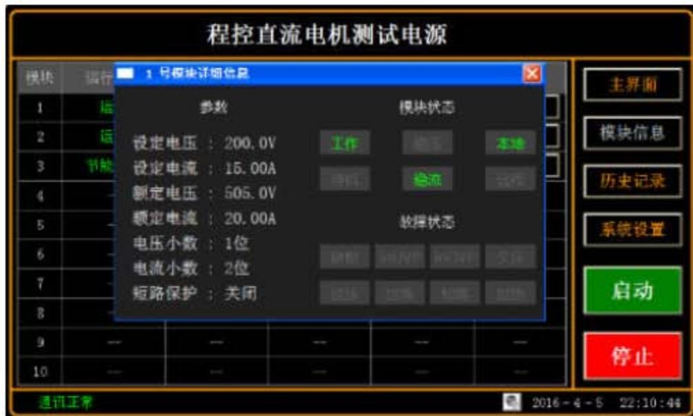
系统由多个模块组成，通过模块信息页面可以查看每台模块的数据和状态。如果有模块发生故障，在下方状态栏也会给出提示。通过本页面可以确定发生故障的模块，以便于维修。
