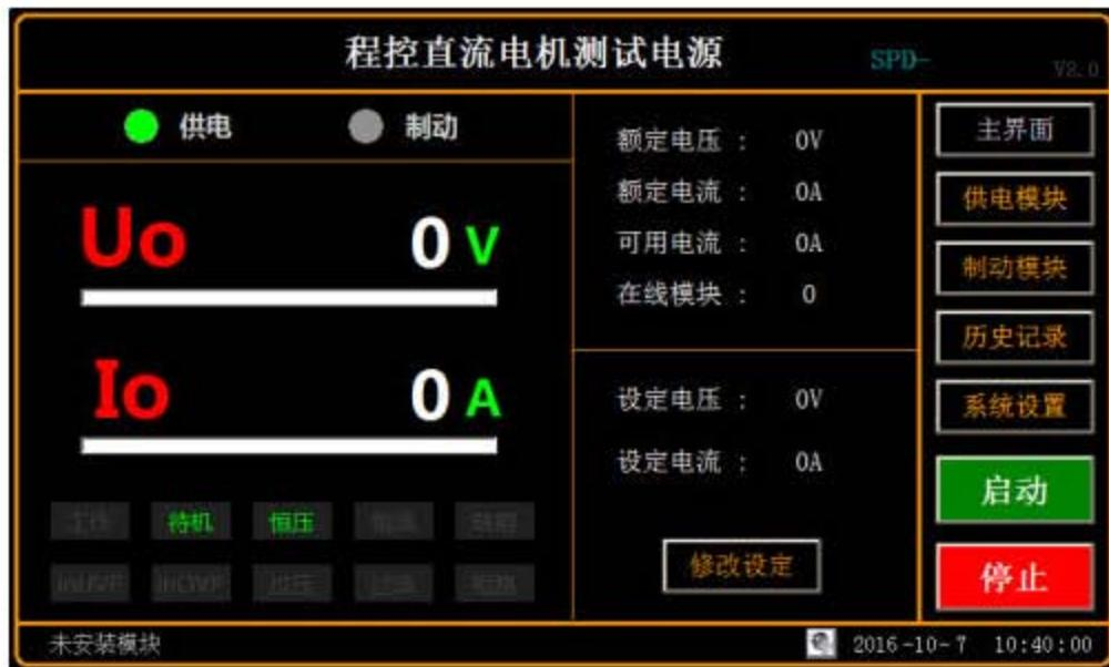
数据查看：系统上电后，显示器进入开机自检，自检结束后，自动打开主界面。在主界面上可以方便的查看设备当前的输出和设定值。
